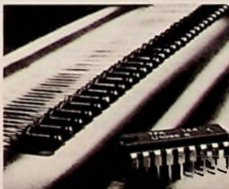
können jedoch durch eine matrixartige Verschaltung der Bauelemente reduziert werden. So werden z. B. für 30 LEDs auf diese Weise nur 11 Leitungen benötigt. Eine spezielle Verschaltung erlaubt jedoch eine Reduktion auf 9 Leitungen. Mit dem Bauelement U 1096 B von AEG-Telefunken können derartige LED-Skalen (Punktanzeige) angesteuert werden, wobei durch Aufstok-
